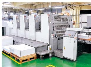
▲印刷時のVOC発生を抑制するオフセット印刷機
