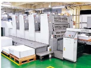
▲印刷時のVOC(揮発性有機化合物)発生を抑制するオフセット印刷機
